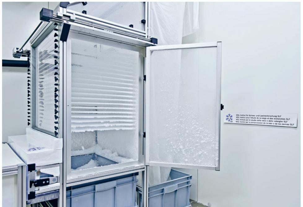
La machine à neige permet de fabriquer de la neige dans le laboratoire du SLF de façon similaire aux nuages: par la formation de cristaux issus de la vapeur d’eau.
