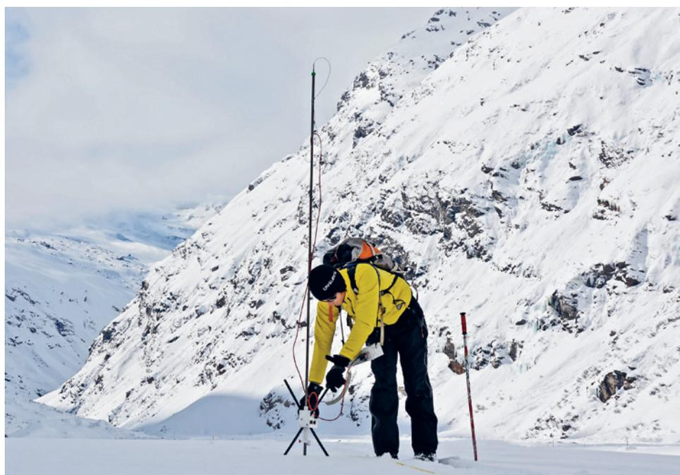
Le SnowMicroPen permet aux chercheurs d'obtenir des mesures précises et rapides de la stratification du manteau neigeux.
