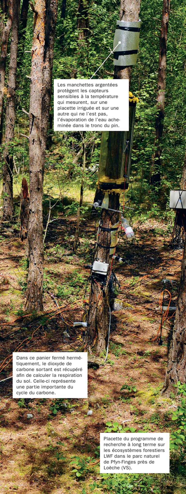
Les manchettes argentées protègent les capteurs sensibles à la température qui mesurent, sur une placette irriguée et sur une autre qui ne l'est pas, l'évaporation de l'eau acheminée dans le tronc du pin.
