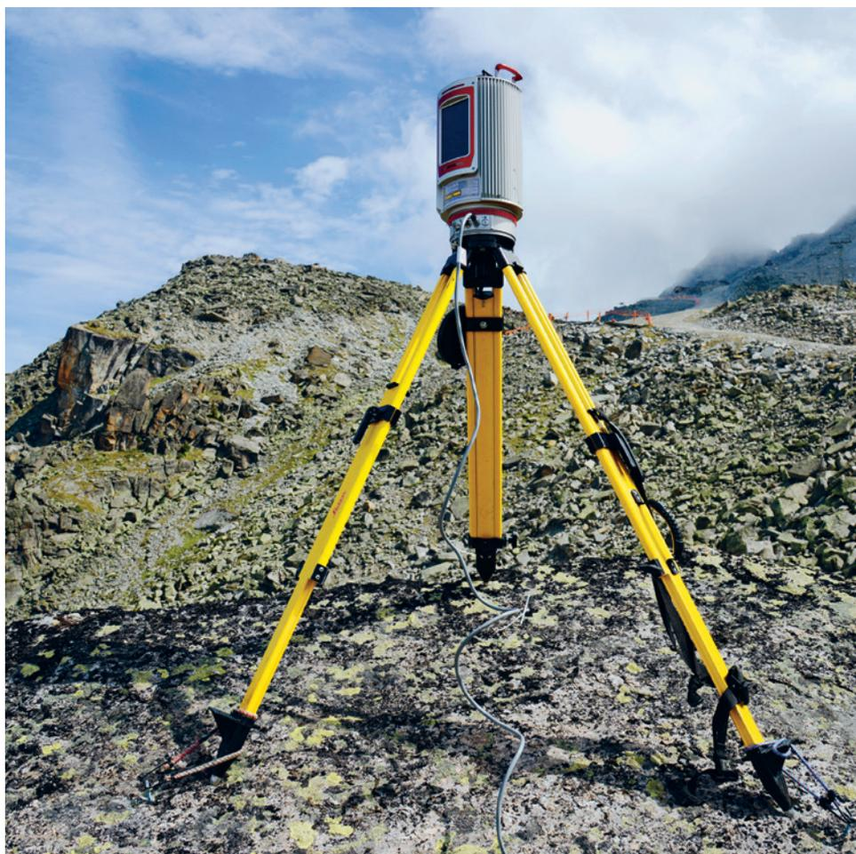
Grâce aux images du terrain prises périodiquement au scanner laser, il est possible de détecter même les petits mouvements du sol.
