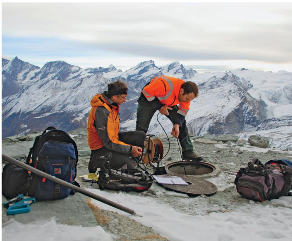
Des techniciens examinent les déformations d'un forage.
