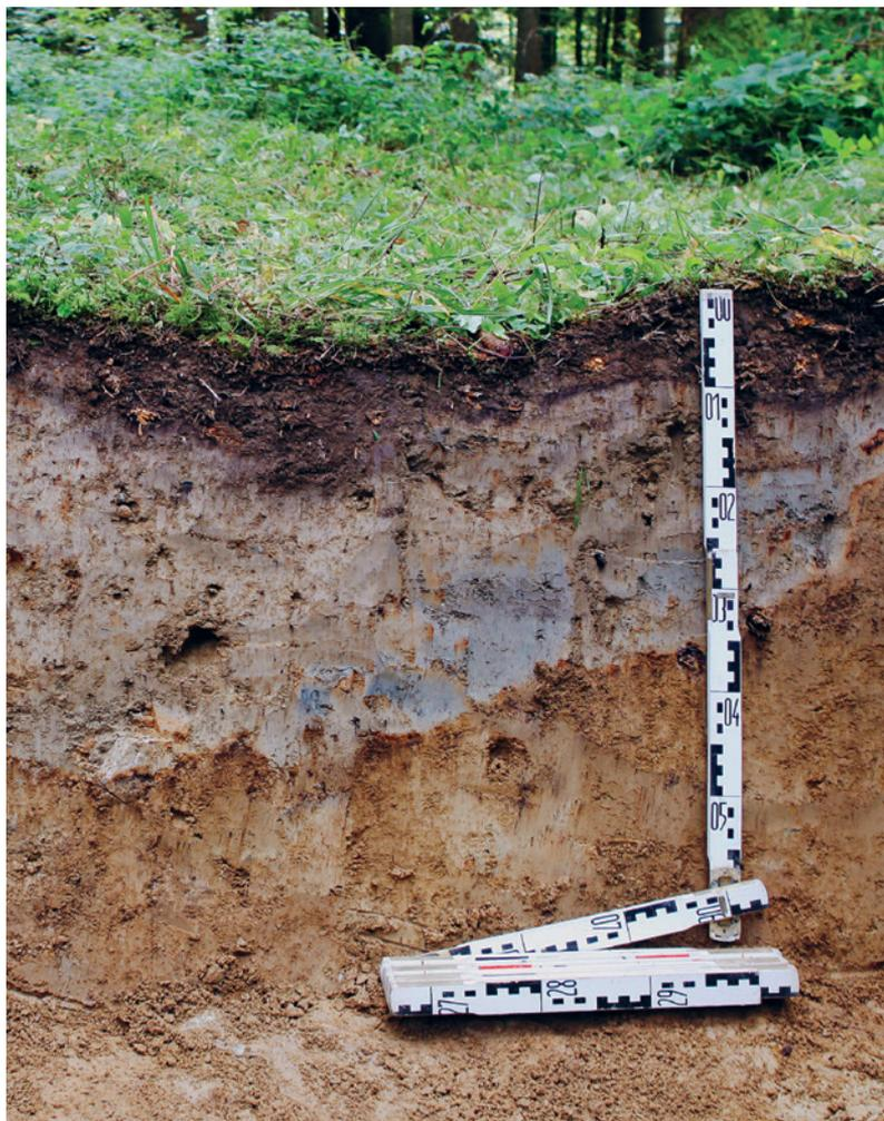
Le profil du sol révèle l'exposition ou non d'un sol à des contraintes mécaniques. La couleur gris bleu indique que l'air ne circule plus à cet endroit, donc que les fonctions du sol sont perturbées.
