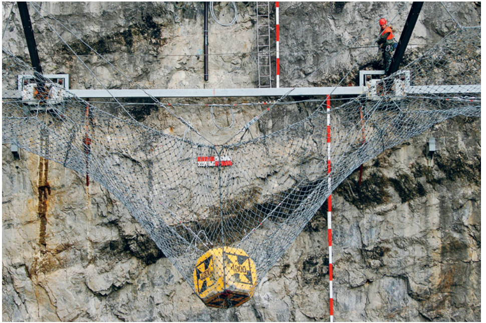
In der Testanlage Lochezen bei Walenstadt prüft die WSL die Zulassung neuer Steinschlag-Schutznetze.
