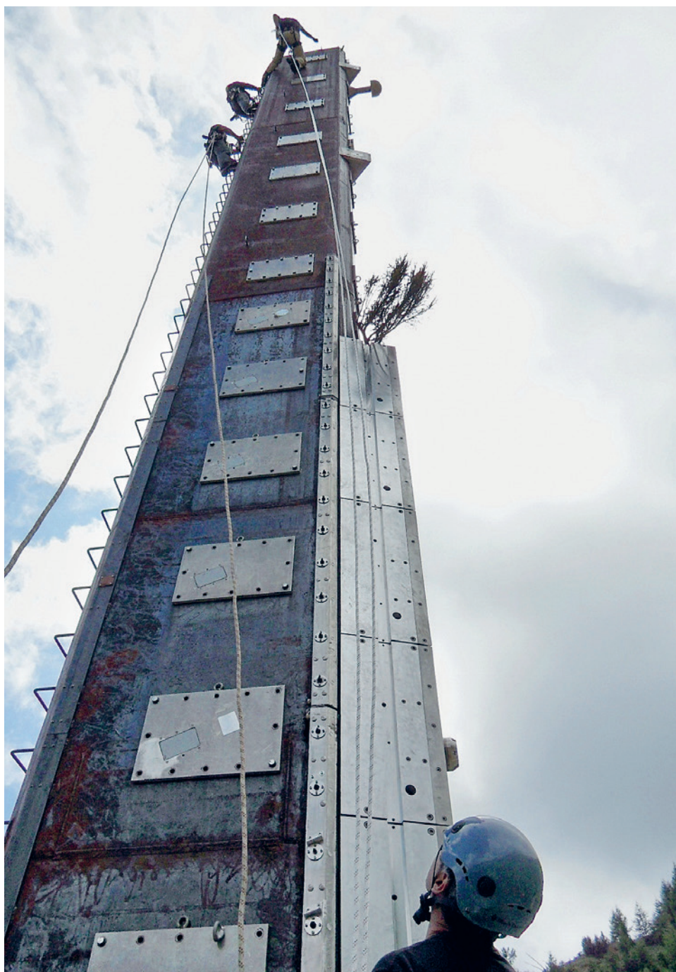
Ein 19 Meter hoher Messmast steht im Vallée de la Sionne mitten in der Lawinenbahn. Er ist mit zahlreichen Messgeräten für Geschwindigkeit, Druck, Dichte und Temperatur der Lawinen ausgerüstet.
