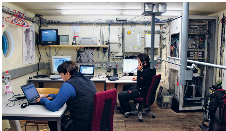
Im Beobachtungsbunker der Lawinen-Grossversuchsanlage überwachen Wissenschaftler und Techniker die Messungen, und Radare messen die Geschwindigkeit der Lawine.
