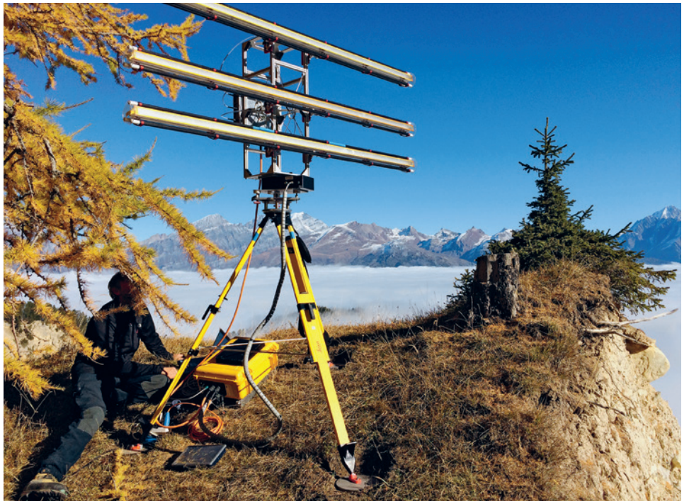
Hoch über dem Illgraben misst ein Radar die Bewegungen von Erdrutschen im Gebiet. Diese Erdrutsche liefern das Material, aus dem Murgänge bestehen.
